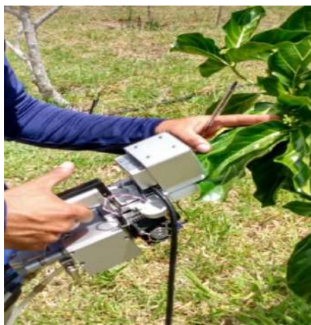
Figura 12: Utilizando o aparelho analisador de fotossíntese- IRGA. Solânea – PB. CCHSA-UFPB, 2019. Brasil. COARACY, T.N.2019.
