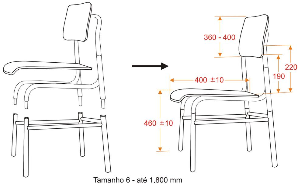
**Figura 45** – Dimensões variáveis da cadeira (tamanho 6) – Fonte: adaptação de ABNT (2003, p.5)
