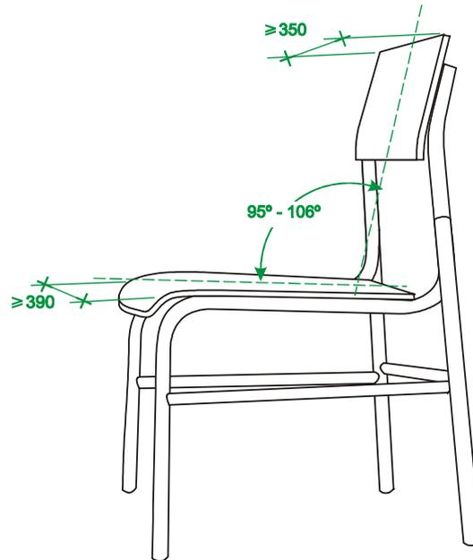
**Figura 43** – Dimensões fixas da cadeira – Fonte: adaptação de ABNT (2003, p.5)
