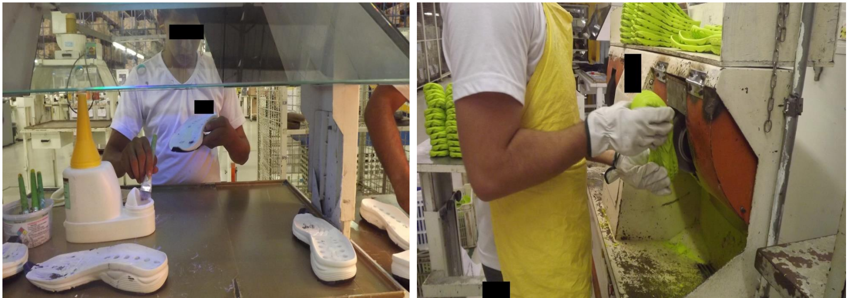
Figura 1 – Atividades desempenhadas pelos trabalhadores: À esquerda, aplicação de cola base; à direita, asperagem de solado.
