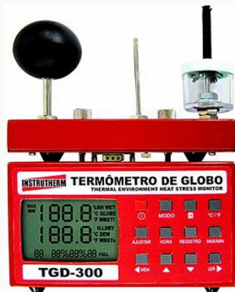
Estação microclimática- BABUC-A Medidor de estresse térmico -TGD 300
