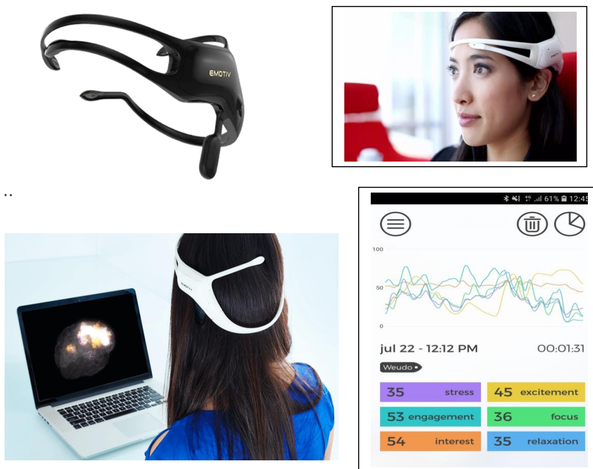
Figura 3- Equipamento de Encefalograma EMOTIV e as saídas com as variáveis métricas cognitivas
