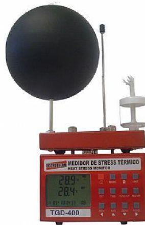
Figura 14- Medidor de estresse térmico da marca Instrutherm
