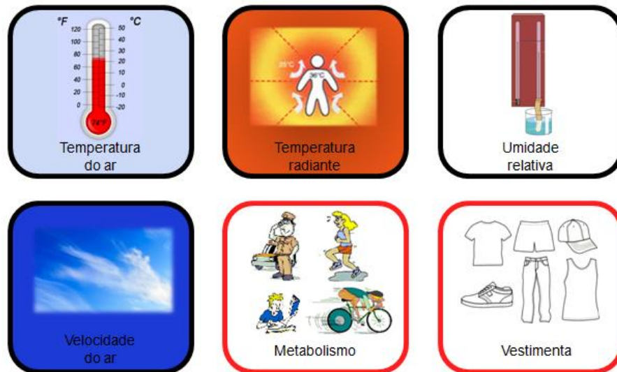
Figura 03 - Parâmetros determinantes do conforto térmico
