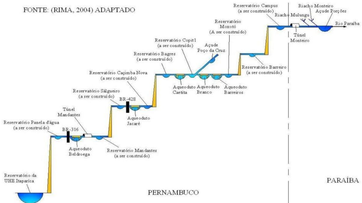
Figura 8 - Esquema do Trecho V do PISF.
