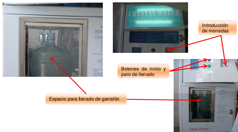
Ilustración 2. Equipo Vending (Tratamiento y despachador de agua)
