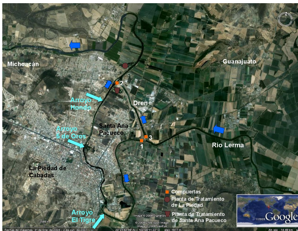
Figura 3. Meandro del río Lerma, con la ubicación de compuertas, plantas de tratamiento y arroyos.
