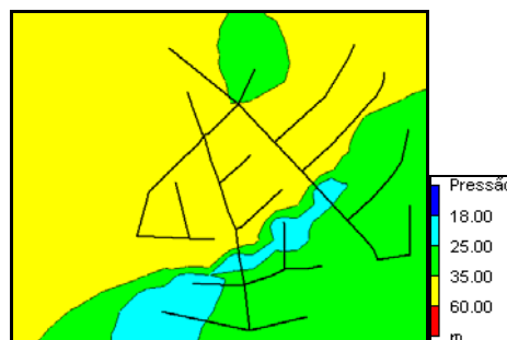
Figura 15 - Distribuição da pressão num sistema de abastecimento de água na hora de menor consumo.
