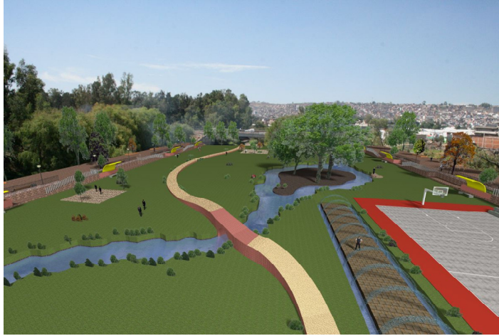
Figura 8. Cauce del río Lerma en el Meandro, con las modificaciones para crear un pase ecológico fluvial. Se puede observar el cauce de estiaje, instalaciones para el esparcimiento y pista para bicicletas (elaborado por Salvador García Espinosa).
