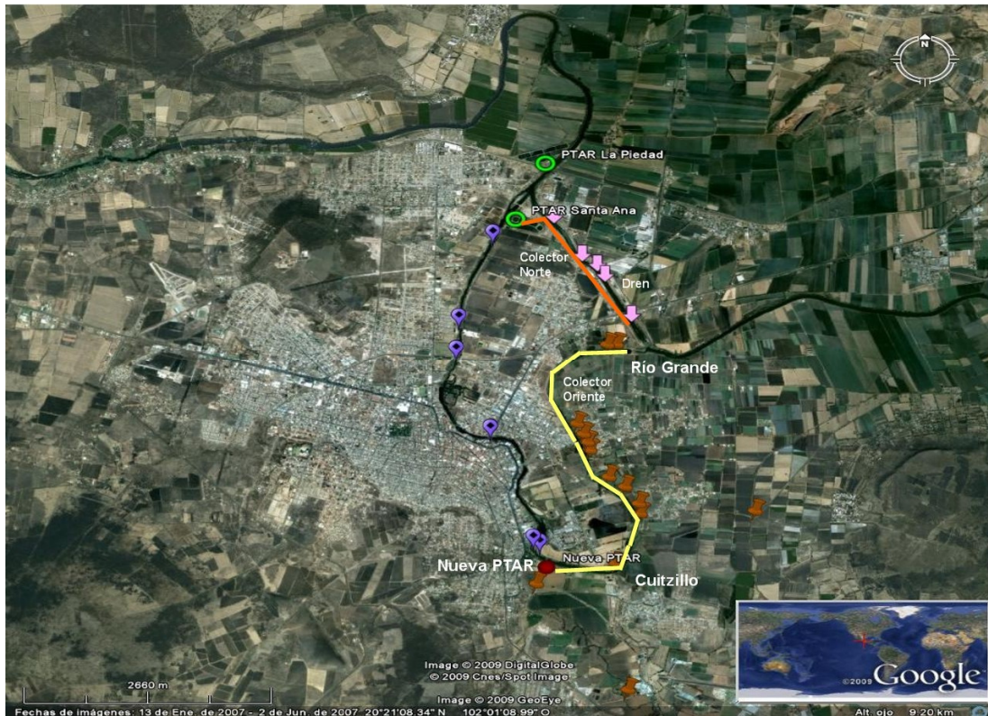
Figura 6. Meandro del río Lerma con la ubicación de las descargas de aguas residuales, y de las propuestas de colectores oriente y norte, así como la ubicación de la propuesta de una nueva planta de tratamiento.
