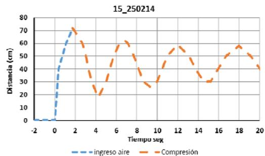
Figura 10. Longitud de la cavidad aire medido durante el transitorio permitiendo el ingreso de aire en la instalación de San Luis Potosí.
