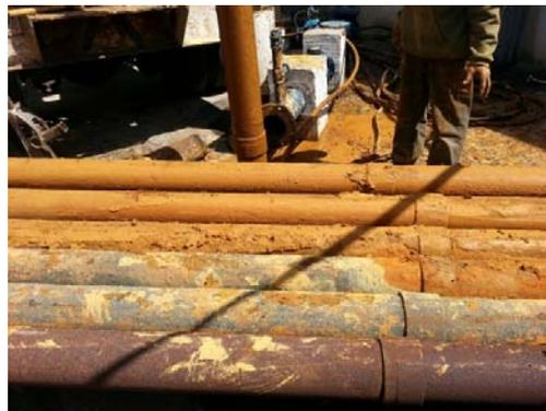
Diferentes condiciones de la tubería expuesta al interior del pozo
