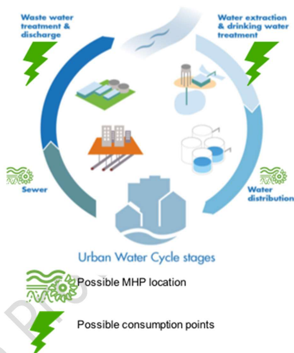
Figura 1. Esquema del ciclo urbano del agua incluyendo los puntos de generación y de consumo de electricidad
