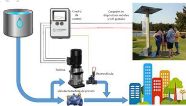
Figura 2. Esquema de montaje de la microturbina de Altafulla
