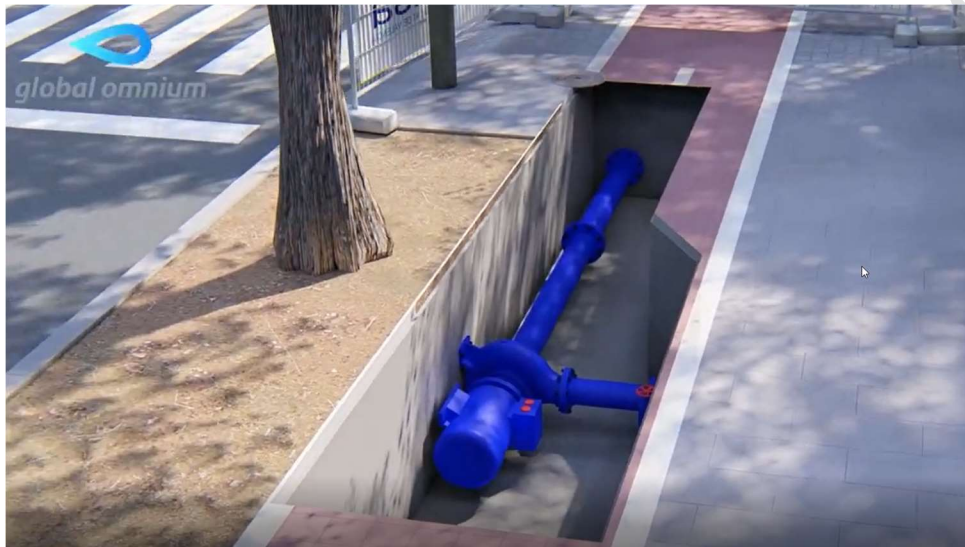
Figura 8. Esquema de la turbina de 23 kW
