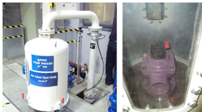
Figura 3. Banco de ensayos de ventosas en admisión en ARI.
