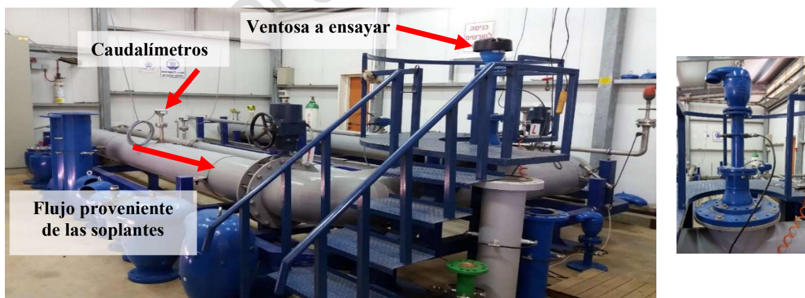
Figura 4. Banco de ensayos de ventosas en expulsión y admisión en Bermad.
