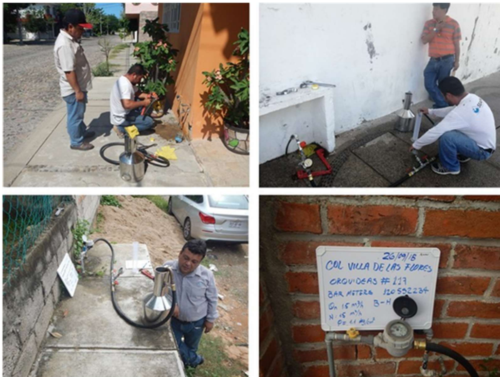
Figura 7. Protocolo de las pruebas de error de medición en tomas domiciliarias.
