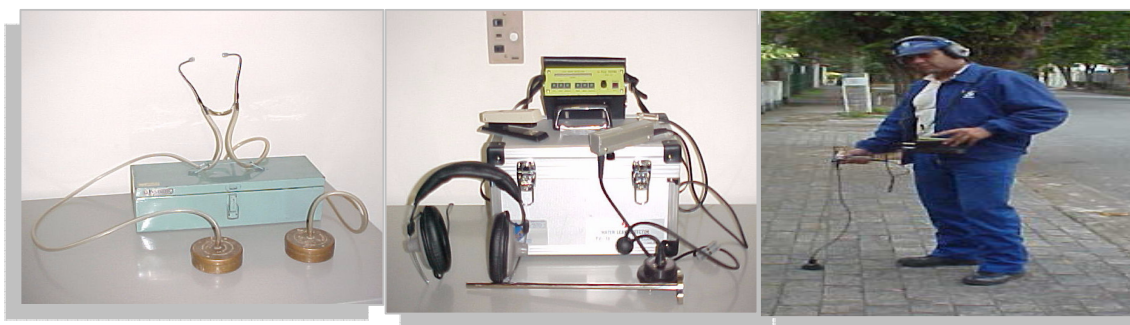
Figura 25. Geofone mecânico, eletrônico e aplicação.
