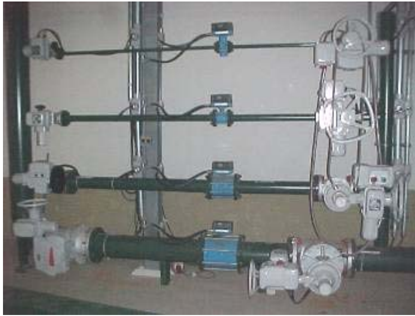
Figura 2 – Linhas de medidas de vazão, válvulas de bloqueio e de controle e medidores de vazão eletromagnéticos
