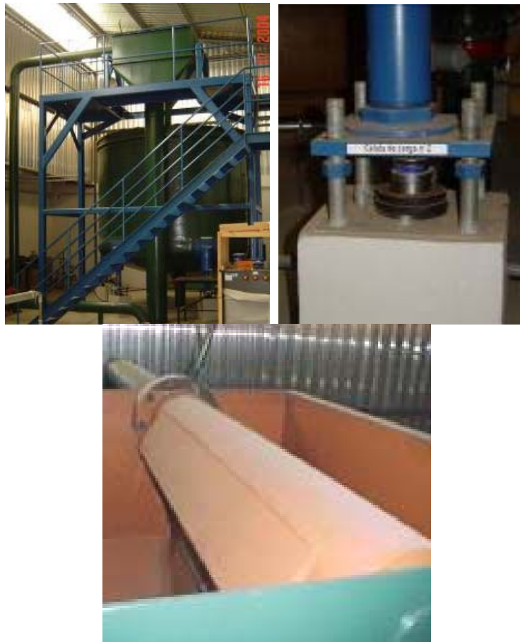
Figura 6 – Tanque de calibração de vazão por pesagem, célula de carga e partidor de vazão
