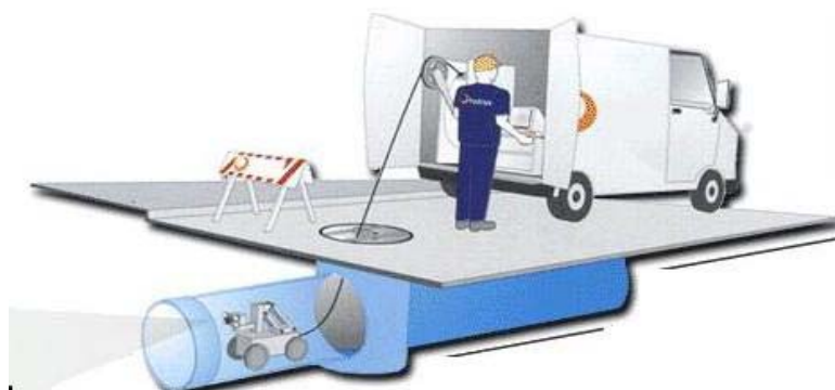
Figura 2.8 - Vídeo inspeção em redes de água e esgoto 9
