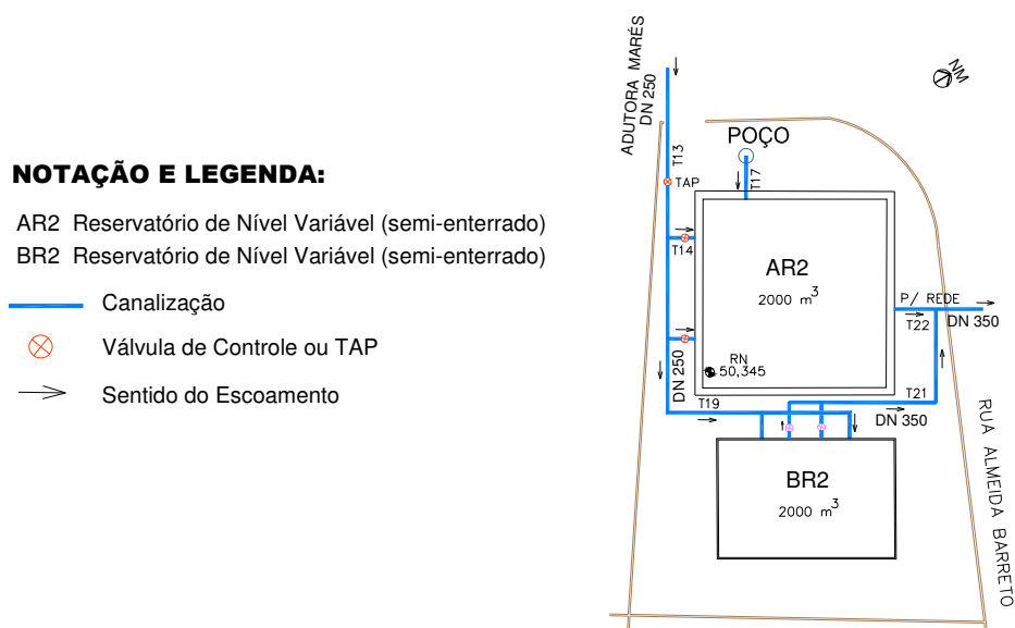
Figura 5.7 – Centro de reservação e distribuição R2.
