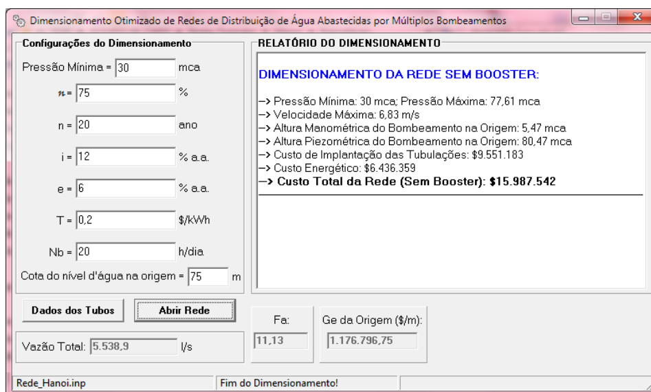
Figura 4.69 - Rede Hanoi dimensionada com bombeamento na origem
