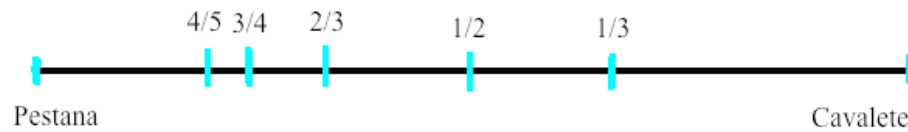
Figura 4 – Esquema dos nós na corda para as posições de referência
