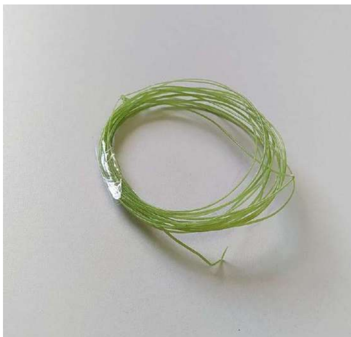
Figura 7 - Filamento resultante a harmonização do PET com o polietileno
