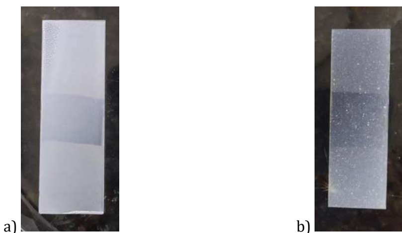
Figura 2 - Revestimentos formados a partir dos mecanismos 1 (a) e 2 (b).
