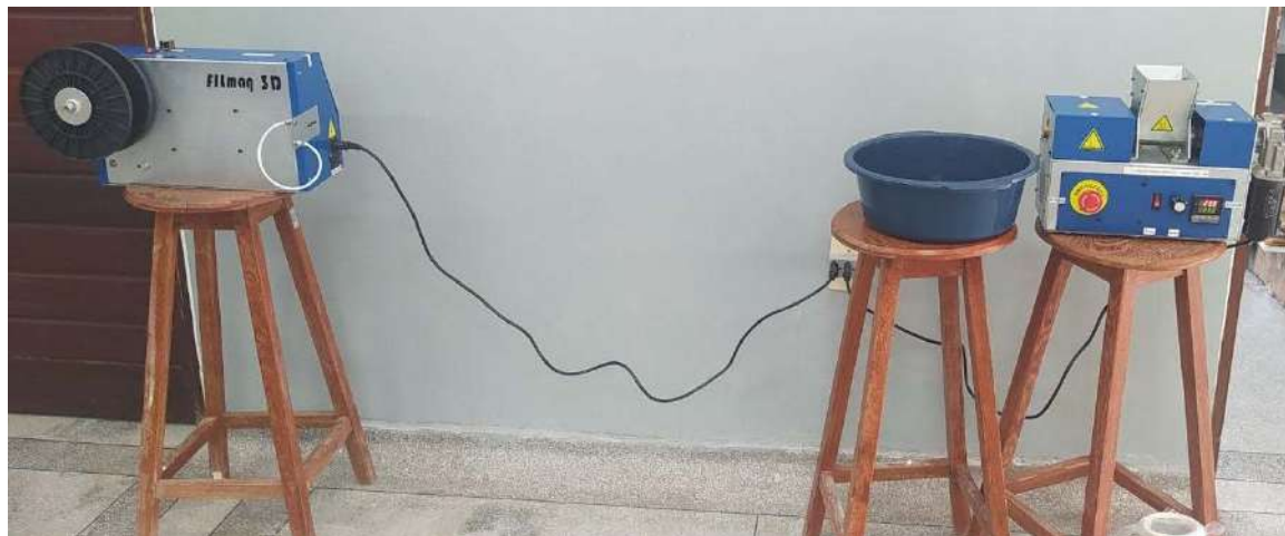
Figura 6 - Extrusora de filamentos " Filmaq3D CV " e enroladora de filamentos " Filmaq3D "
