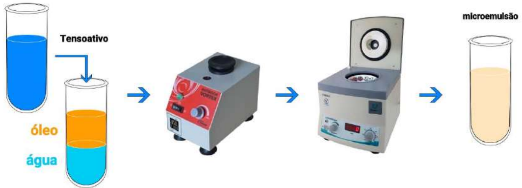
Figura 1 - Esquema de preparação das microemulsões.
